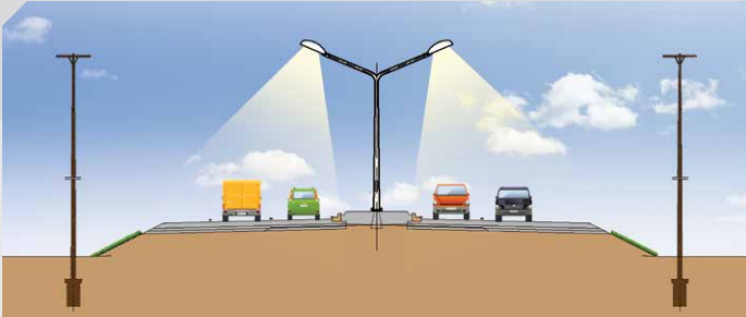
ถนน 4 ช่องจราจร ติดตั้งเสาไฟฟ้ากิ่งคู่สูง 9 เมตร ดวงโคมชนิด HPS ขนาด 250 วัตต์ (2x250W.)
