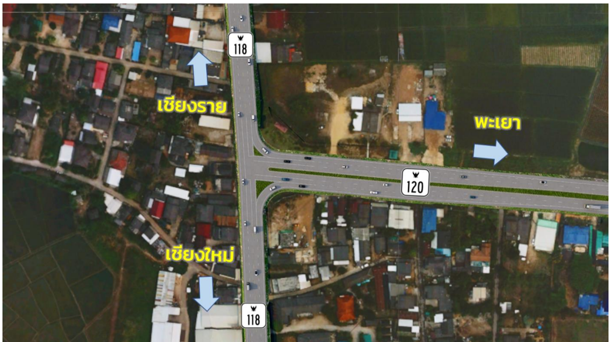
รูปที่ 5.4-4 รูปแบบทางแยกบริเวณจุดตัดถนนทางหลวง 118
